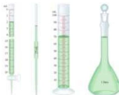
**Figura 1.** Vidrarias para medição de volume
