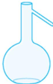
**Balão de destilação:** utilizado para efetuar destilações simples. O braço lateral é usado para fazer a ligação ao condensador.
