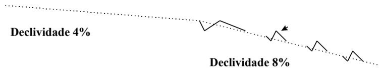
Dimensionamento de terraços de infiltração para a área em estudo.
