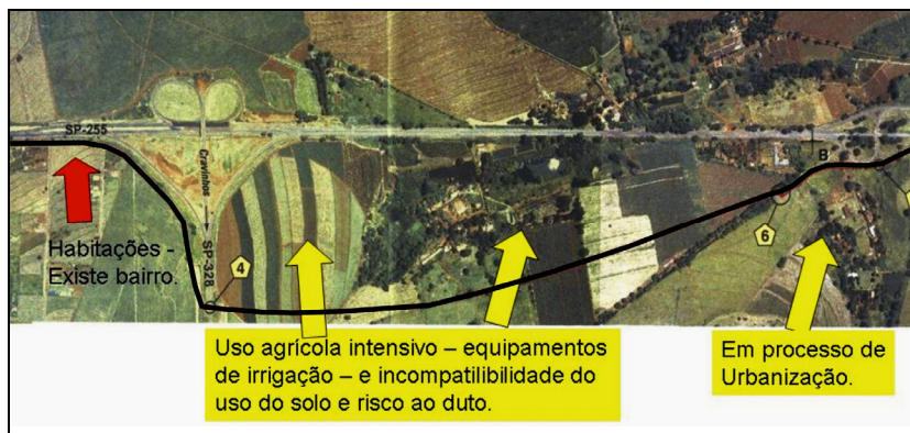
Figura V.10 - incompatibilidades com o uso do solo nas proximidades de duto implantado em Ribeirão Preto-SP.
