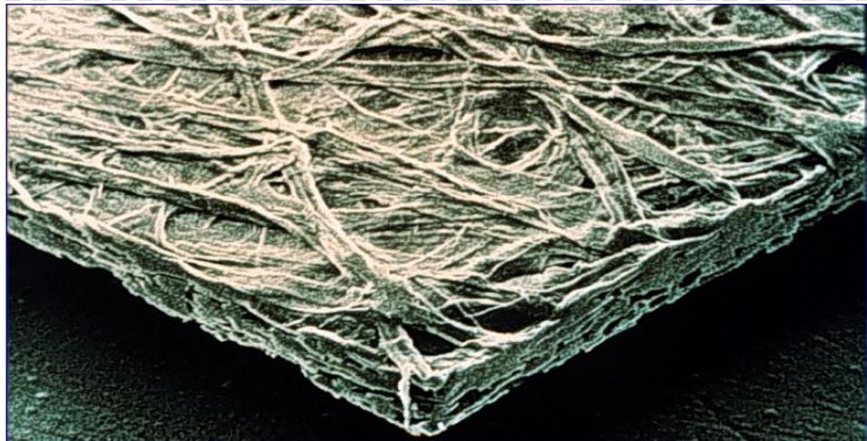
**Figura 2.** Microscopia eletrônica de varredura de um cartão formado por fibras de uma polpa celulósica
