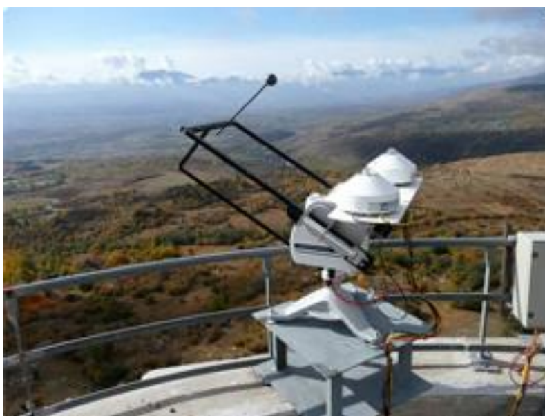
Figura 2.19 – Disco de sombreamento com rastreamento em dois eixos.
