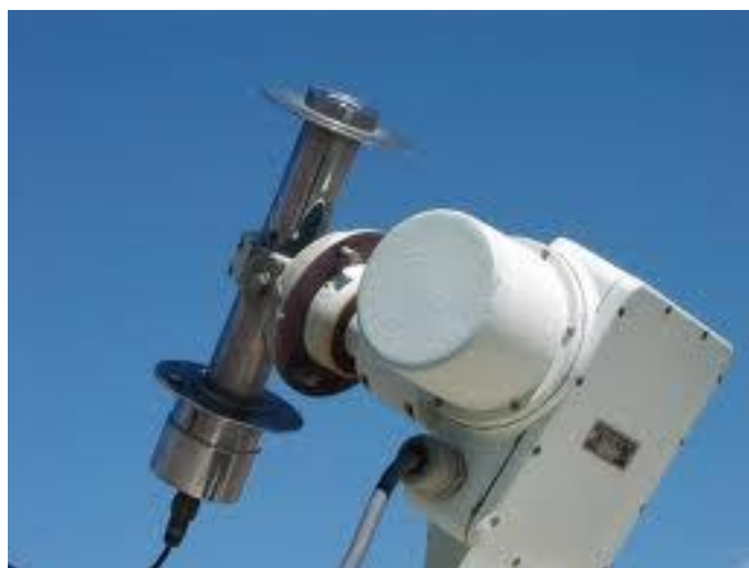
Figura 2.17 – Pireliômetro montado em um rastreador solar.
