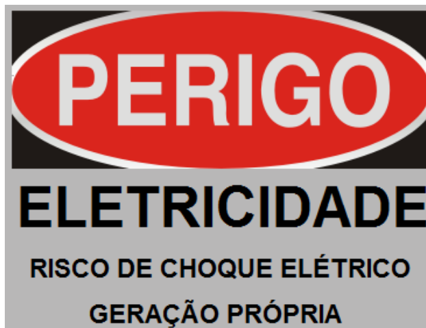
Figura 7.3 – Exemplo de placa de advertência de risco de choque elétrico devido à geração própria de sistemas conectados à rede.
