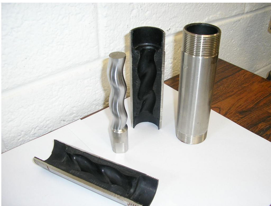
Figura 5.16 – Corte de uma bomba (somente o elemento bombeador) tipo parafuso, permitindo visualizar o rotor helicoidal e a forma construtiva interna de seu estator em material sintético (borracha); externamente, a bomba é o tubo em aço inox visto à direita. Fonte: (GALDINO, 2005).
