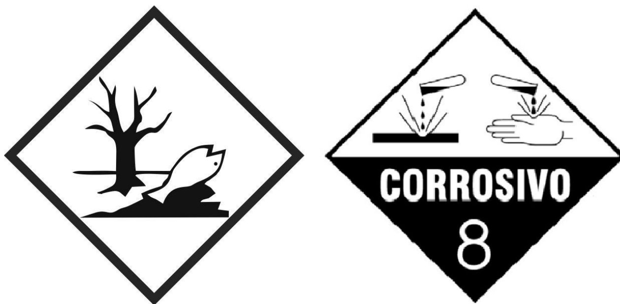
Figura 4.23 – Sinalização aplicável a baterias Chumbo-ácido.
