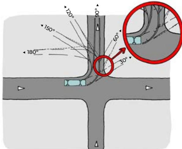
**Figura 6.** Detalhe do raio insuficiente para a conversão
