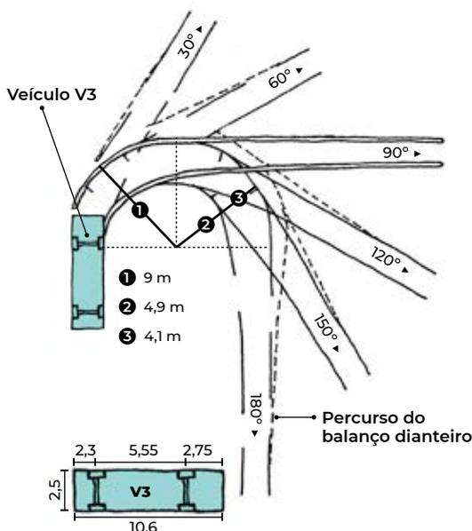
**Figura 4.** Gabarito de raio de giro – caminhão de dois eixos com 10,6 m de comprimento
