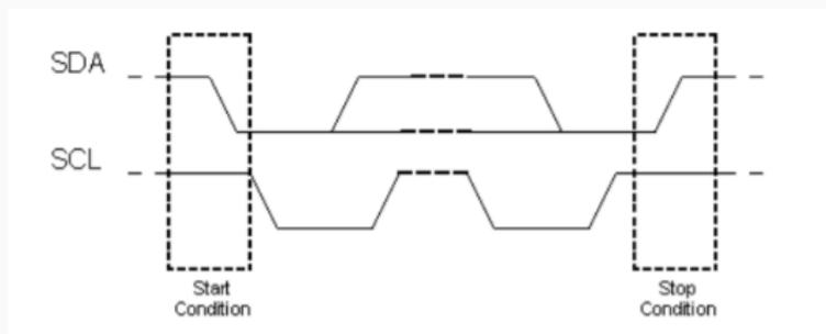
A transferência não ocorre simultaneamente (half-duplex)
