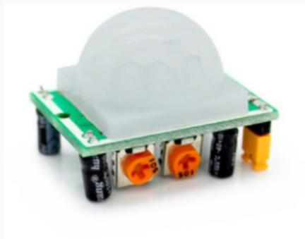
O Sensor de Movimento PIR DYP-ME003<sup>6</sup> consegue detectar o movimento de objetos que estejam em uma área de até 7 m. Caso algo ou alguém se movimentar nesta área o pino de alarme é ativo. É possível ajustar a duração do tempo de espera para estabilização do PIR através do potenciômetro amarelo em baixo do sensor bem como sua sensibilidade. A estabilização pode variar entre 5-200 seg.
