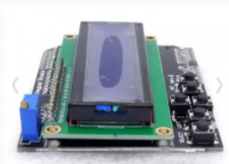
Esse Display LCD <sup>9</sup> para Arduino com Teclado (conector de pino macho) dispõe de um display azul de 16x2 caracteres e 6 botões momentâneos, da esquerda para a direita, SELECT, ESQUERDA, PARA CIMA, PARA BAIXO, DIREITA e RESET. Este Shield pode ser conectado diretamente ao seu Arduino UNO, Duemilanove ou MEGA. Os pinos digitais 5, 6, 7, 8 e 9 São usados como interface para o LCD. **Preço possível: R\$ 38,90.**
