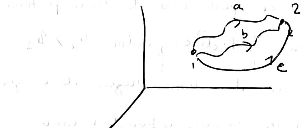
Para algumas forças (força gravitacional, força elástica, força eletrostática), a integral  $\int \vec{F} \cdot d\vec{r}$  não depende da trajetória (especificada pela relação entre  $\vec{F}$  e  $d\vec{r}$ ), mas depende somente de seus valores calculados em 1 e em 2.
