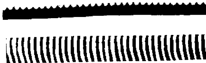
FIG. 4.5 — Formação de escamas de peixe no cavaco contínuo.
