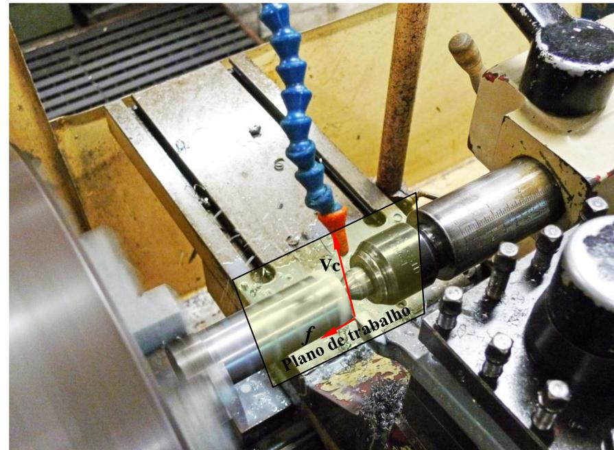
Plano admitido de trabalho da ferramenta ( $P_f$ ): é aquele que, passando pelo ponto de corte escolhido, é perpendicular ao plano de referência da ferramenta ( $P_r$ ), paralelo à direção admitida de avanço.
