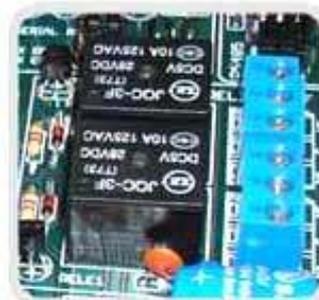
Disponibilizamos 2 relés independentes NA/NF que permite acionar cargas motores, máquinas, ou outros tipos de cargas.
