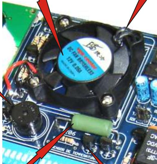
**Resistência de aquecimento.** Podemos ligar ou desligar a resistência com o intuito de variar a temperatura ao redor do sensor Lm35, desta forma podemos desenvolver diversas aplicações de práticas utilizando o aquecedor e o sensor de temperatura.
