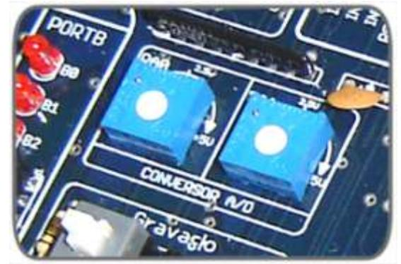
Esquema de acionamento do conversor A/D
