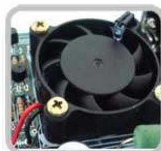
Ventoinha para simulação e testes de aplicações com PWM. Através do canal CCP do PIC, você poderá controlar a velocidade de giro da ventoinha e via sensor infravermelho ler sua rotação.
