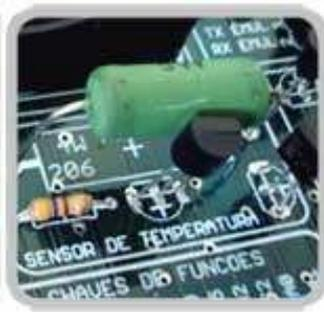
Via PWM do PIC, você poderá controlar o aquecimento da resistência disponível. Disponibilizamos o sensor de temperatura LM35, ideal para você ler e medir a temperatura ambiente ou do aquecedor.
