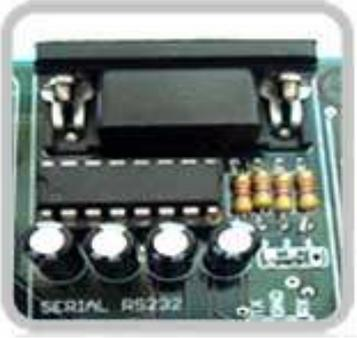
Canal de comunicação serial RS232 e Canal serial Emulada via software. Permite que você utilize 2 seriais RS232 em seus projetos
