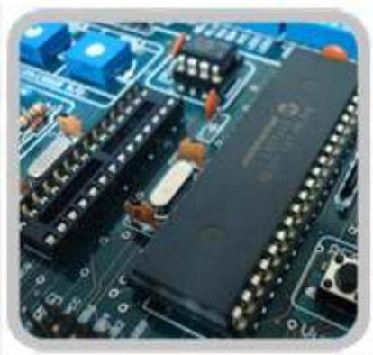
O Kit PICGenios suporta diversos PIC da *Microchip* tais como: **PIC16F877A / PIC18F442 / PIC18F452 / PIC18F458 / PIC18F4520 / PIC18F2550 / PIC18F2450 / PIC18F4550 / PIC16F873/876** / dentre outros.
