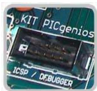
Conector ICSP e modo Debugger. Através desse conector, você poderá gravar outros microcontroladores PIC, assim como poderá ligar o Debugger ICD2 da *Microchip* para testar a aplicação em tempo real.
