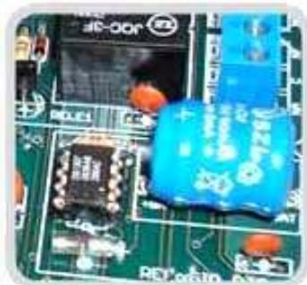
O kit possui um relógio Ds1307 altamente preciso que permite que você desenvolva aplicações de delay ou temporizadores com intervalos de ms, seg, min, hora, dia, mês e ano.
