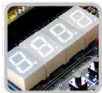
Permite o acionamento de 4 displays de 7 segmentos por varredura. Estes dispositivos são muito utilizados.
