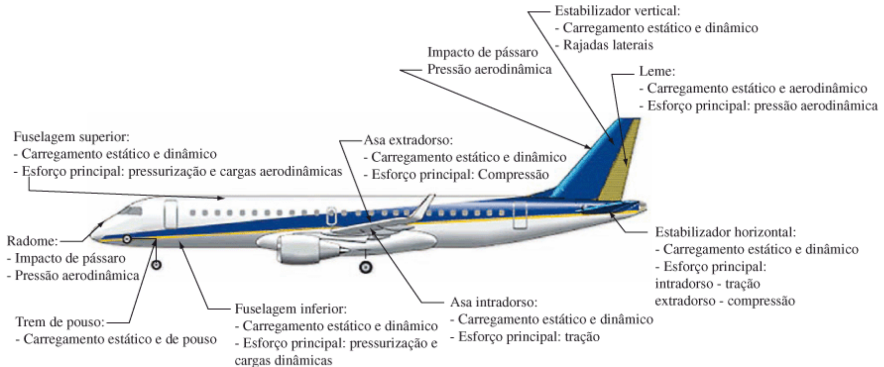
Figura 3. Principais cargas envolvidas na operação de uma aeronave (cortesia Embraer).
