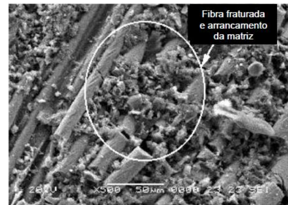
Arrancamento de fibra
