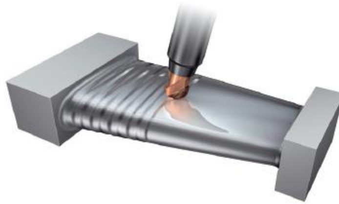
Fresamento de perfis (acabamento/semi)
