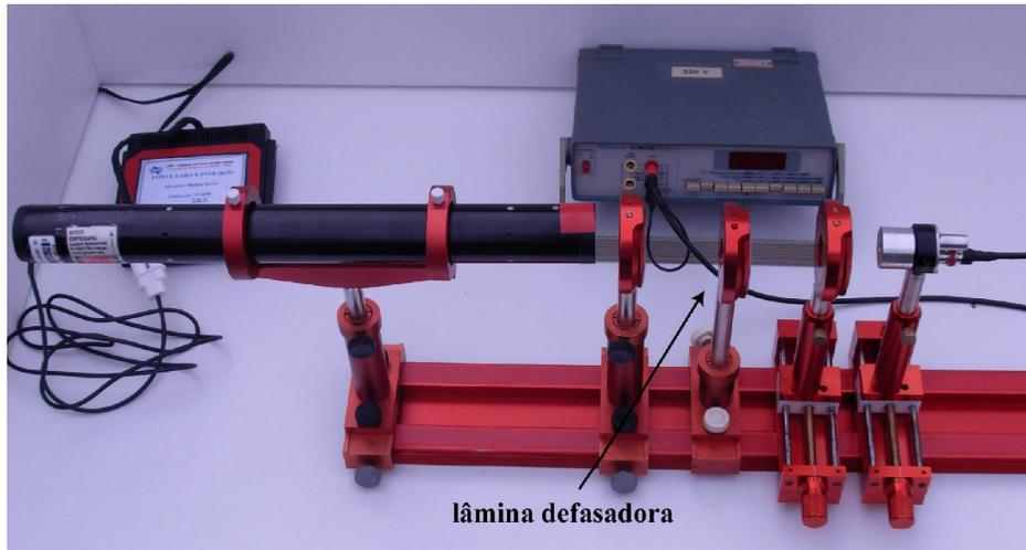
Figura 5 – Fotografia da montagem experimental. A lâmina de meia onda é posicionada entre dois polarizadores.
