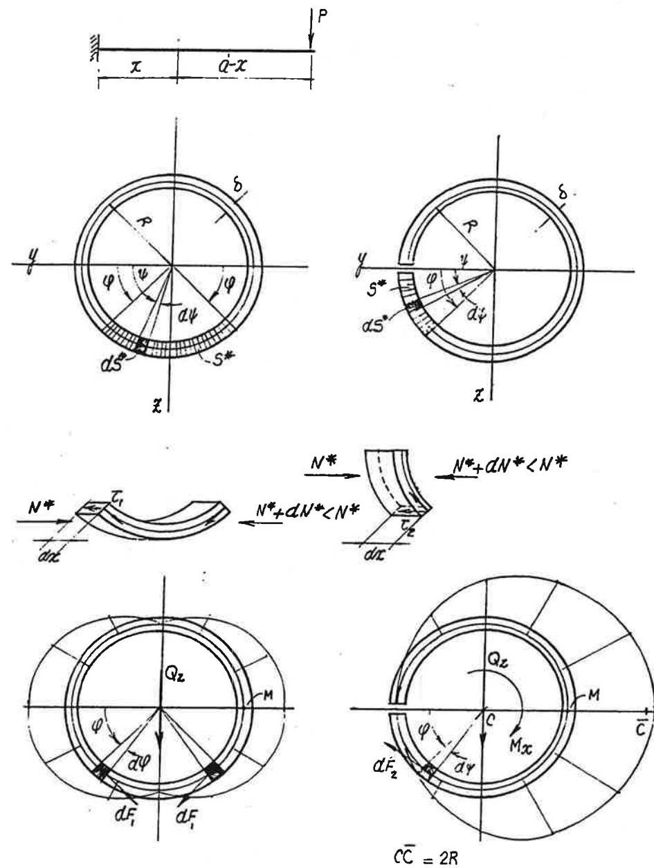
Considerando o equilíbrio segundo a direção longitudinal dos elementos indicados na fig., obtém-se, na seção delgada fechada,
