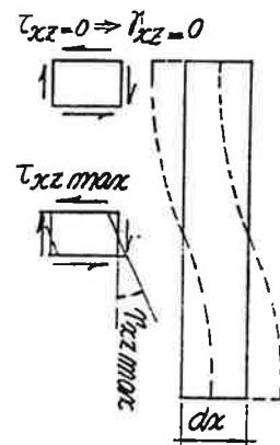
Considerando-se um ponto  $P$  no contorno da seção transversal, conclui-se que à componente  $\tau_{xz}$  corresponde a componente  $\tau_{xy}$ , de modo que a resultante  $\tau$  seja, como se mostra na fig., tangente ao contorno.
