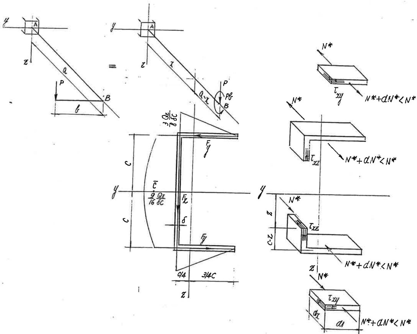
A distribuição de tensões tangenciais  $\tau_{xy} = \tau_{yx}$  nos segmentos horizontais, obtida a partir do equilíbrio segundo a direção x do elemento de dimensão dx caracterizado pela coordenada s, é dada por:
