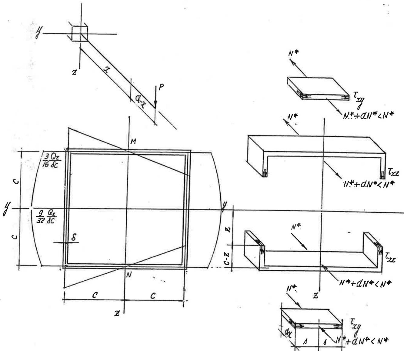
A distribuição de tensões tangenciais  $\tau_{xy} = \tau_{yx}$  e  $\tau_{xz} = \tau_{zx}$  pode ser obtida considerando-se, como se mostra na fig, o equilíbrio na direção longitudinal de elementos de dimensão  $dx$ , simétricos relativamente ao eixo  $y$  e caracterizados pelas coordenadas  $s$  e  $z$ . Assim, para as tensões  $\tau_{xy} = \tau_{yx}$ , tem-se:
