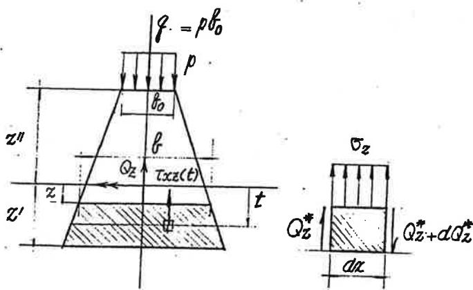
A distribuição das tensões normais  $\sigma_z = \sigma_z(z)$  na face superior do elemento é determinada a partir do equilíbrio de forças segundo a direção z, ou seja:
