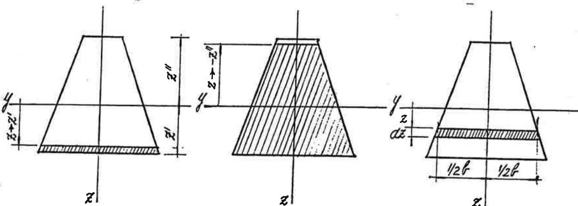
Por outro lado, como se mostra na fig., quando se passa da coordenada  $z$  para a coordenada  $z+dz$ , o momento estático passa de  $M_{sy}^*$  para  $M_{sy}^* + dM_{sy}^*$ , onde:
