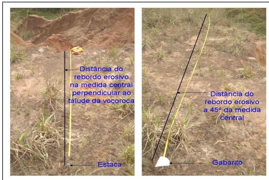
Fotos 02 e 03 – Medição perpendicular ao rebordo erosivo e medição a 45° com o uso do gabarito, respectivamente.
