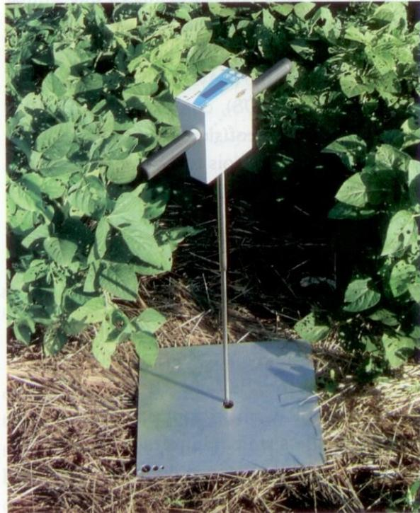
Figura 2.12. Penetrômetro eletrônico.
