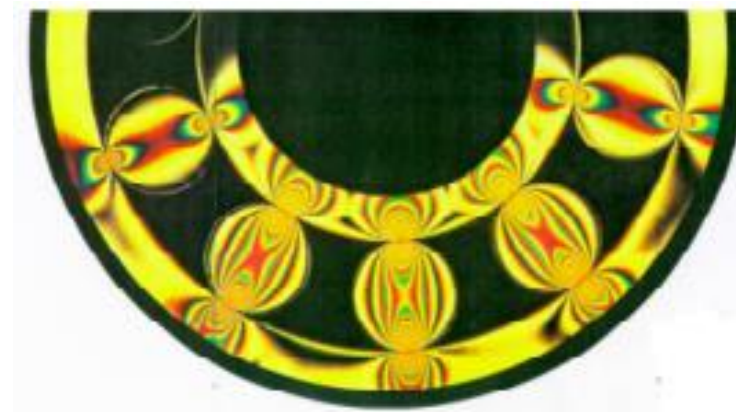
Franjas isocromáticas nos contatos rolos/pista de um rolamento
