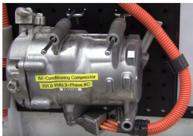
Figura 9.34 – Compressor para o sistema de ar-condicionado
