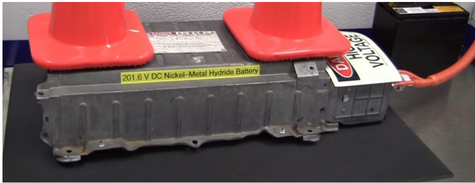
Figura 9.19 – Bateria de Alta Tensão visualização externa.
