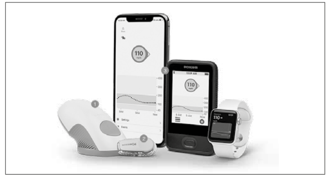
Figura 3. Componentes do sistema Dexcom G6: (1) autoaplicador; (2) sensor e transmissor; (3) monitor.
