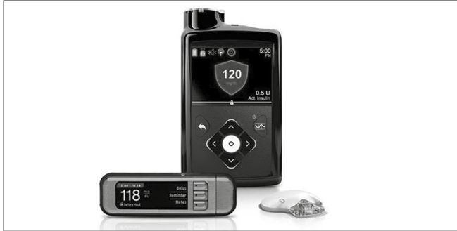
Figura 11. MiniMed 670G: bomba de insulina, glicosímetro Contour® Next Link 2.4, que envia os resultados de glicemia capilar diretamente para a bomba e o sensor, e o transmissor Guardian Link 3, que se conecta ao sensor.
