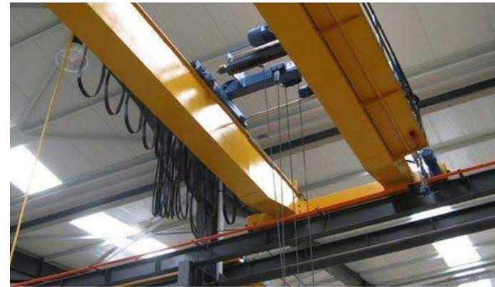
Fig.2: Ponte-rolante dupla viga apoiada.
