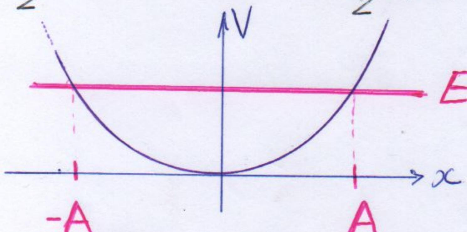
Clasicamente a amplitude  $A$  define os os pontos de retorno da oscilação.
