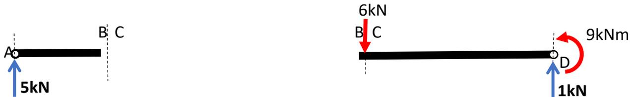
Pelo Teorema do corte, divide-se a estrutura apenas em duas partes na seção de interesse
