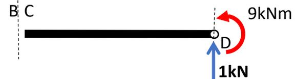
4. **Seção C** (aplicação do Teorema do corte)
