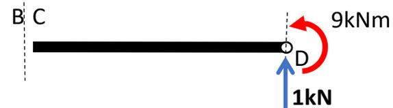
**Os esforços solicitantes que atuam em uma seção transversal de uma barra podem ser obtidos cortando a barra nesta seção e reduzindo no seu centro de gravidade todos os esforços externos aplicados do outro lado do corte.**
