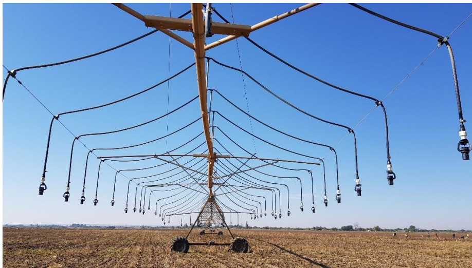
Figura 5. Expansor implantando em pivô central para reduzir intensidade de precipitação.
