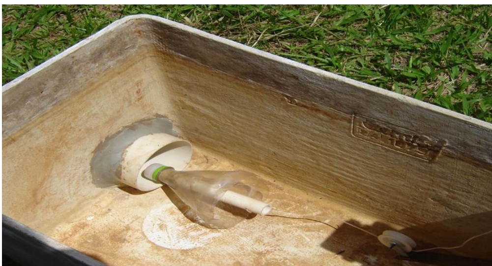
Figura 3. Detalhe da parte superior de uma garrafa PET de 2 L que atuará como um plug no interior da tubulação.
