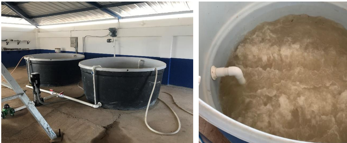
Figura 9. Vista geral do sistema de fertirrigação composto por turbina de ar para homogeneização da solução, caixas para diluição, motobomba injetora e medidor volumétrico.
