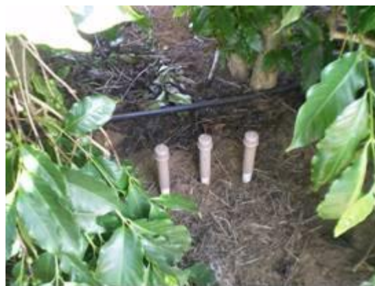
Figura 15. Bateria de tensiômetros para manejo da irrigação de café, em três profundidades.
