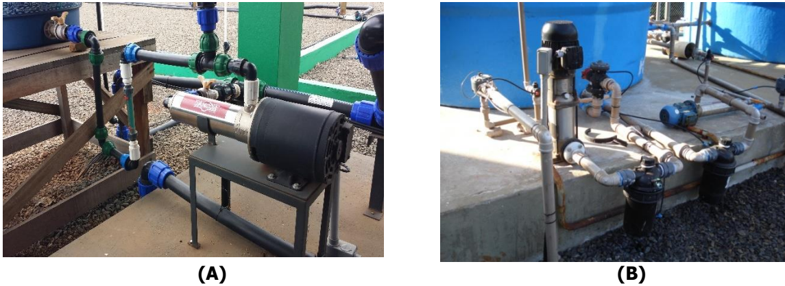
Figura 8. Sistema de fertirrigação utilizando bomba injetora de aço inoxidável (A) Palaretti (2009), e (B) NaanDan Jain (2021).
