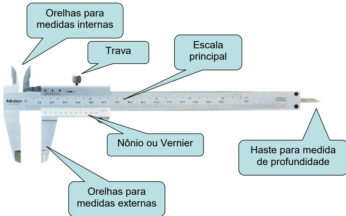
Figura 3.6 – Paquímetro típico e seus principais componentes
