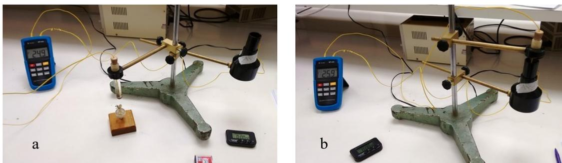
Figura 1: Imagens do arranjo experimental utilizado. Na situação (a) um termopar está inserido no tubo de ensaio que se aquece e outro está afixado externamente ao cilindro com o *cooler* para a medição de  $T_R$ , enquanto na situação (b) o tubo de ensaio com glicerina é inserido no cilindro com *cooler* para resfriamento.
