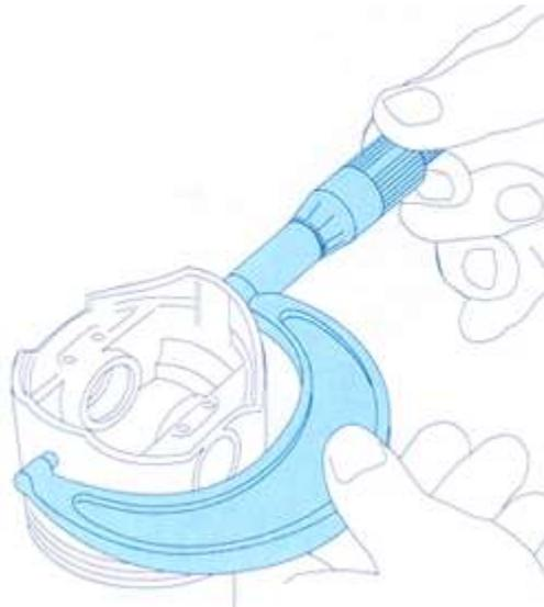
Figura 3.4 – Realizando uma medida com um micrômetro simples.
