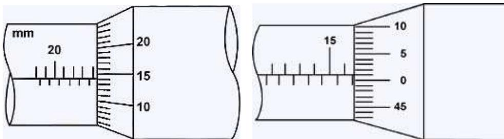
Figura 3.5 – Exemplos de leitura de um micrômetro.
