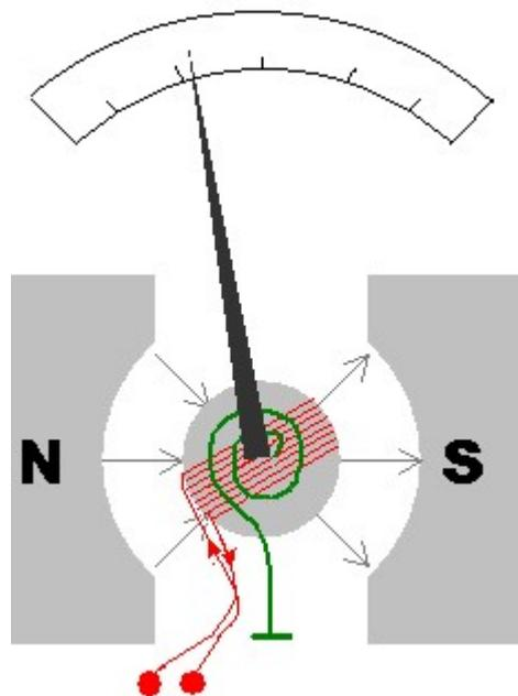
Figura 3.11 – Galvanômetro normalmente utilizado em multímetros analógicos.
