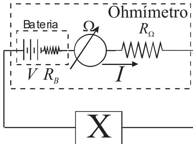
Figura 3.13 – Esquema de um ohmímetro e sua utilização.
