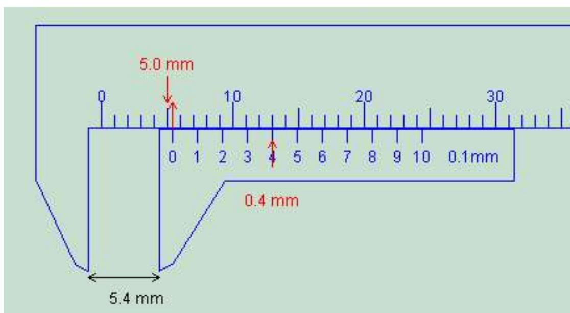
Figura 3.10 – Realização de uma leitura no paquímetro.
