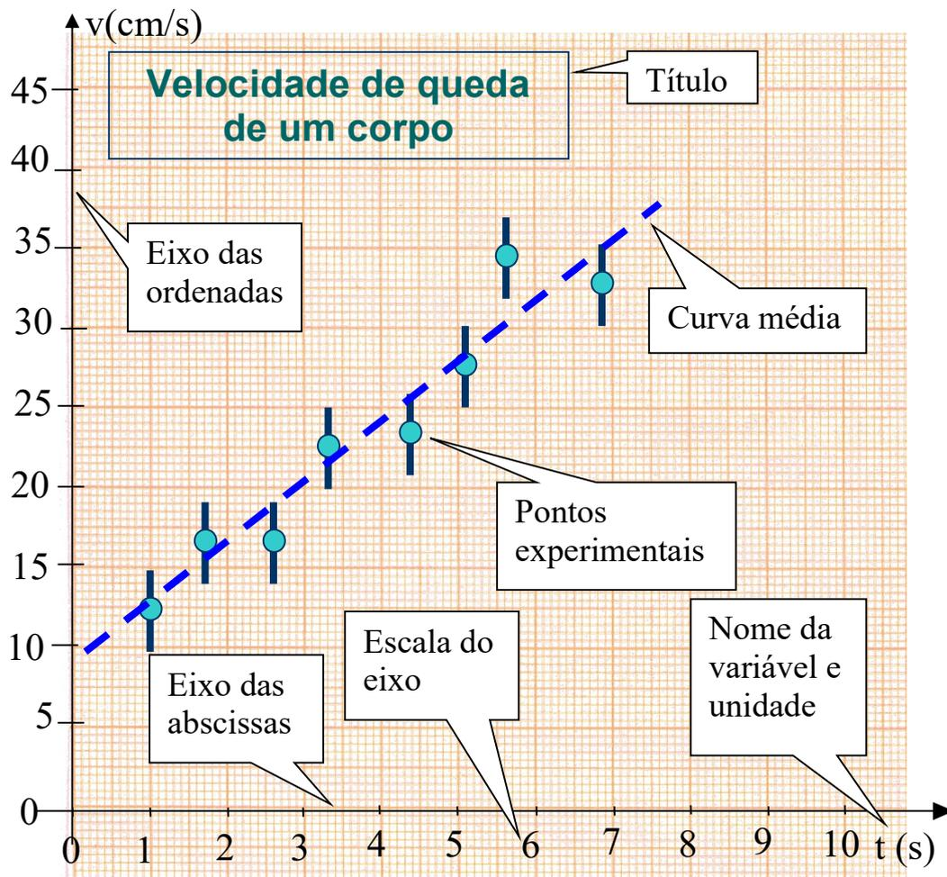
Figura 3.1. Componentes típicos de um gráfico científico padrão.
