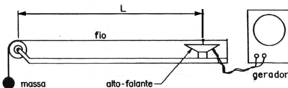
Figura 2. Arranjo experimental utilizado para estudar o fenômeno de ressonância de um fio tensionado.
