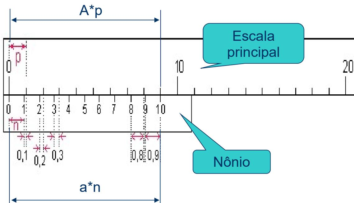
Figura 3.8 – Esquema de um nônio ou escala Vernier.
