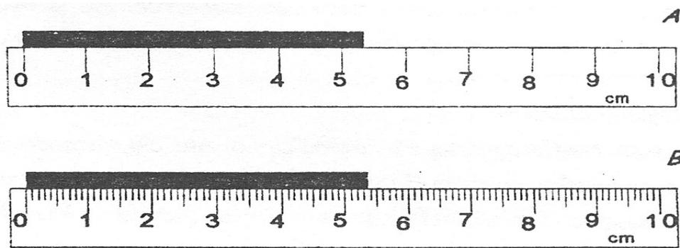
Figura 3.1 - Representação de duas régua com precisões diferentes.
