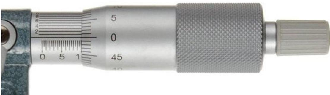
Figura 3.3 – Foto detalhando o parafuso micrométrico graduado de um micrômetro simples.
