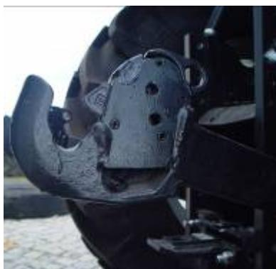
Figura 34 - Na extremidade dos braços inferiores existem engates rápidos (*quick couplers*) para ligar ao cabeçote da alfaia.
