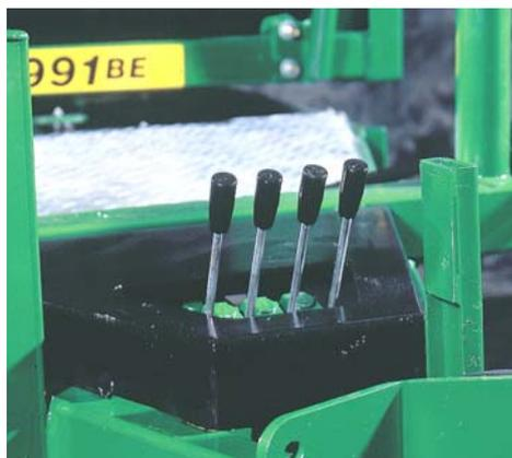
Figura 57 - Conjunto de válvulas que distribuem óleo para os diversos actuadores [www.mchale.net](http://www.mchale.net)
