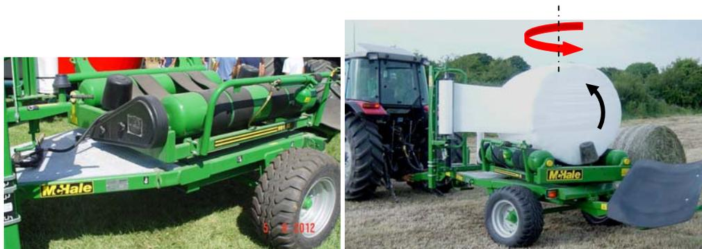
Figura 54 - Mesa rotativa em torno de dois eixos
