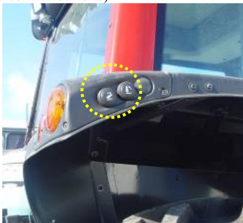
**Figura 37 – Comandos no guarda-lamas para subida e descida dos braços inferiores em operação de montagem de alfaias**
