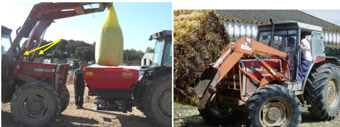
Figura 19 - Um par de CHDE actuados em paralelo rebate a lança do carregador frontal. Para o mesmo caudal, os CHDE encolhem mais depressa do que estende; para uma mesma pressão, os CHDE exercem maior força a estender do que encolher. Como consequência o carregador tem mais força para levantar carga e desce mais depressa para o solo. Controlo de Equipamentos e Mecanização Aplicada.
