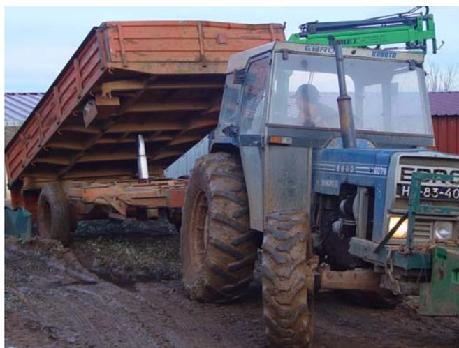
Figura 16 - O semi-reboque (*farm trailer*) da figura dispõe de um CHSE para rebater (*tip*) a caixa; O peso da caixa fará recolher a haste do cilindro. Aula do Mestrado de Olivicultura e Azeite - Herdade de Torre de Figueiras (Monforte)
