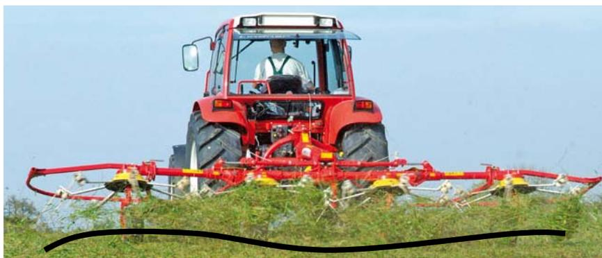
**Figura 49 - Os cilindros hidráulicos deverão estar ligados a válvula do SESH com flutuação**
