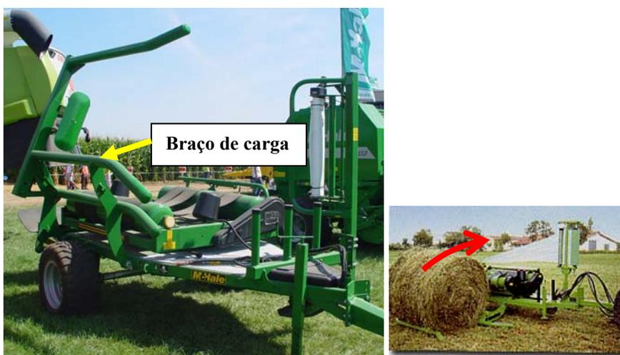
Figura 53 - Braço de carga do fardo para a mesa rotativa [www.mchale.net](http://www.mchale.net)
