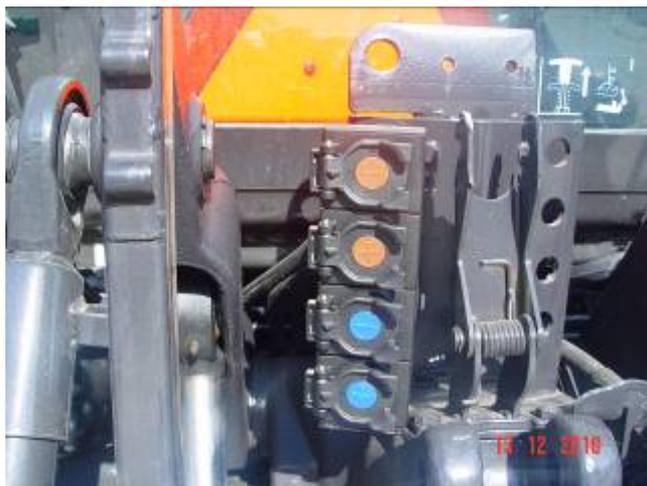
**Figura 45 – Tomadas do SESH do tractor (acoplamento fêmea) devidamente protegidas por tampas de plástico (*dust caps*)**
