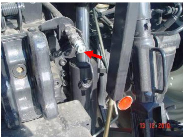
Figura 59 - Tomada de retorno de baixa pressão (*free flow return line*)
