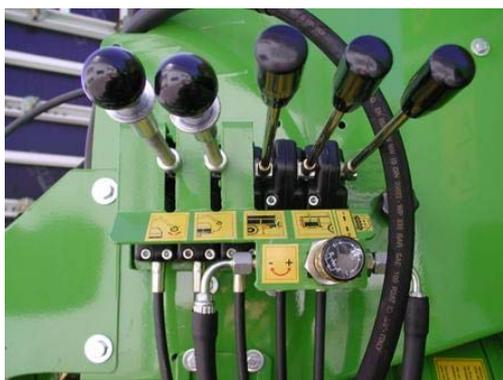
Figura 61 – Comandos do bloco de válvulas direccionais e de controlo de caudal que permitem dirigir e regular o fluxo de óleo para cilindros e motores hidráulicos dos diferentes órgãos do semi-reboque misturador e distribuidor de ração com sistema hidráulico autónomo <http://www.faresinagri.com/it/>
