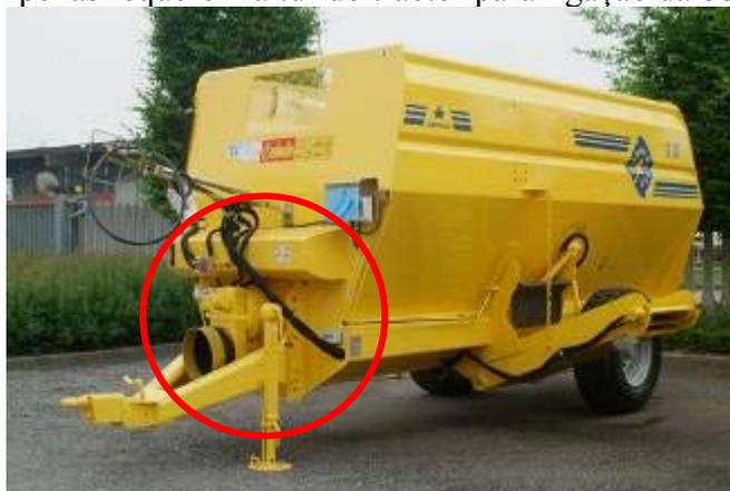
Figura 60 – Semi-reboque misturador e distribuidor de ração (*mix feeders*) são exemplos frequentes de equipamentos com sistema hidráulico autónomo [www.sgariboldi.it](http://www.sgariboldi.it)
