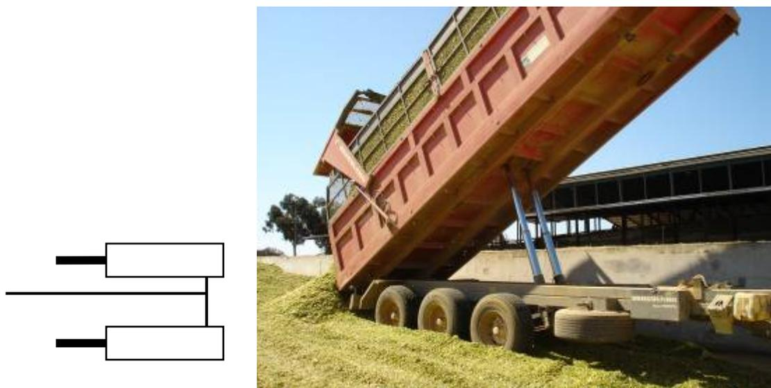
Figura 18 - Semi-reboque basculante com caixa rebatida por dois cilindros hidráulicos de simples efeito (CHSE), em paralelo. Tratores e Equipamentos Automotrizes 2011/12 – Visita à herdade dos Padres
