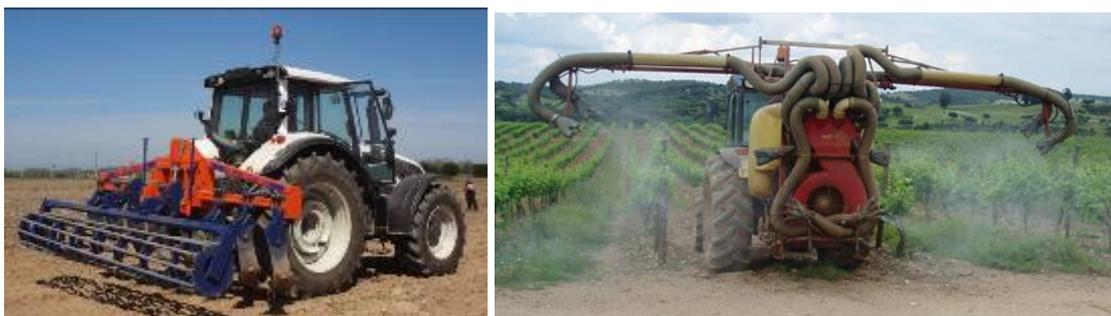
Figura 38 – Transporte de alfaia montada nos 3 pontos e aplicação de fungicida com pulverizador montado: duas situações de utilização do controlo de posição da alfaia (CPA)
