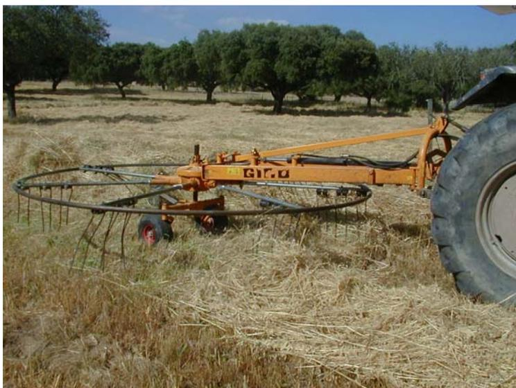
**Figura 46 – Virador juntador de feno cujo posicionamento lateral em relação ao tractor é efectuado por um cilindro hidráulico de duplo efeito ligado ao SESH do tractor**
