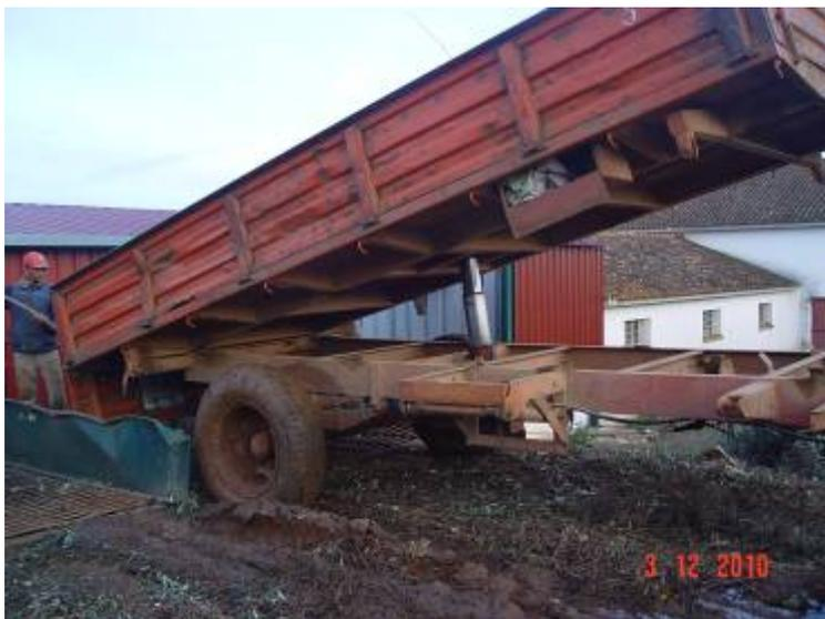
Figura 52 – CHSE de rebatimento da caixa de um semi-reboque. Visita de estudo à herdade de Torre de Figueira
