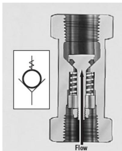
Figura 25 - Válvula de retenção <http://www.hydraulicspneumatics.com/>
