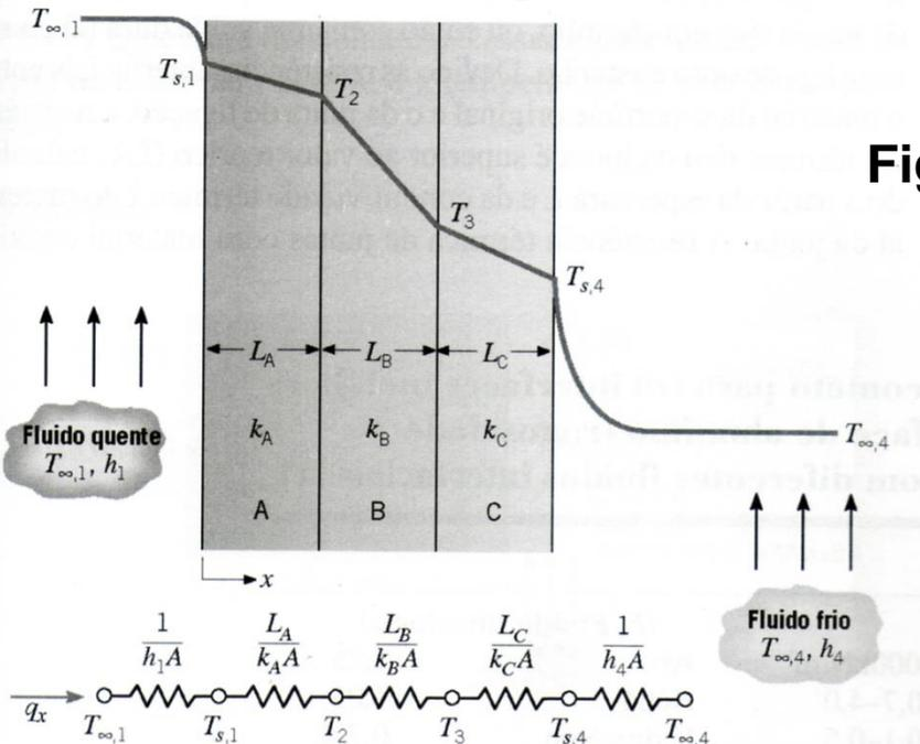
Figura 1: Parede composta em série.
