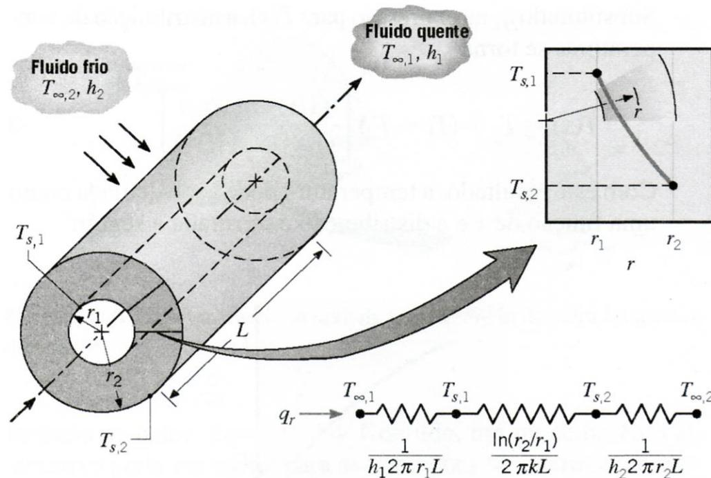
Figura 3: Cilindro oco com condições convectivas na superfície.
