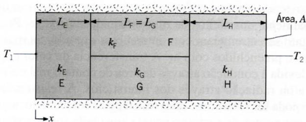
Figura 2: Parede composta em paralelo.
