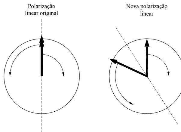
Figura 4 – Efeito de uma diferença de fase entre as componentes circulares da onda.
