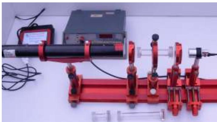
Figura 10 – Montagem experimental, com a cubeta entre os polarizadores.
