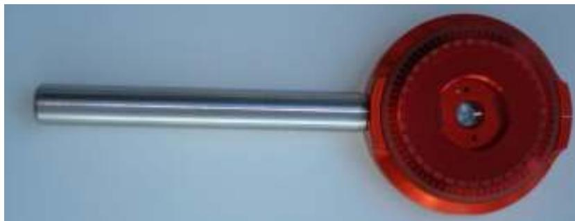
**Figura 5 – Polarizador, com suporte e escala angular.**
