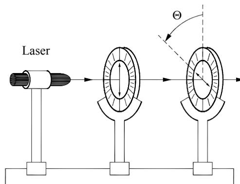
**Figura 2 – Representação esquemática de dois polarizadores com eixos de transmissão deslocados de um ângulo  $\Theta$ .**
