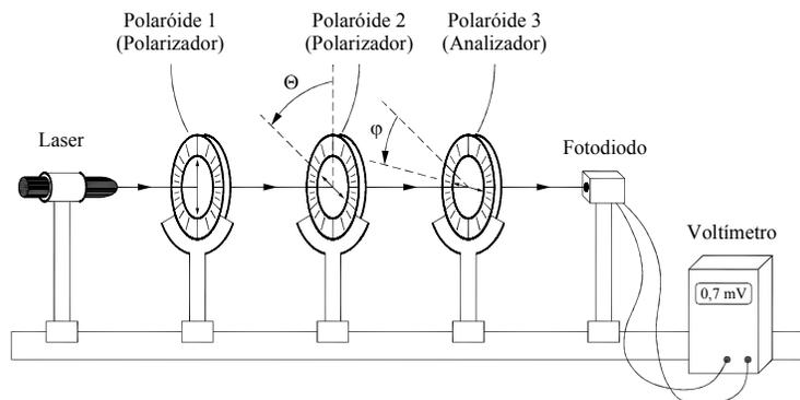
Figura 8 – Esquema do aparato utilizado na determinação do ângulo de transmissão de um polarizador utilizando polarizadores cruzados.
