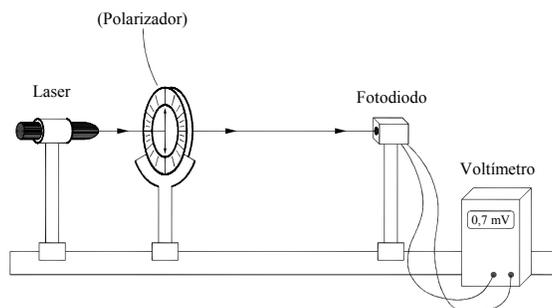
**Figura 6 – Esquema utilizado para determinar a porcentagem de polarização de um laser.**
