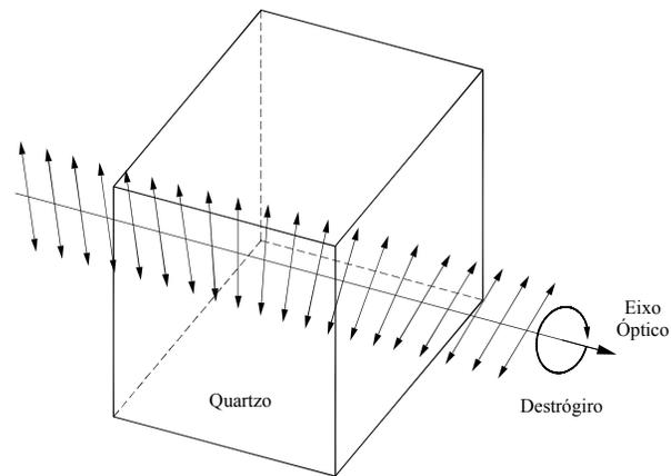
**Figura 3 – Mudança na direção de polarização da luz provocada por um cristal destrógiro**
