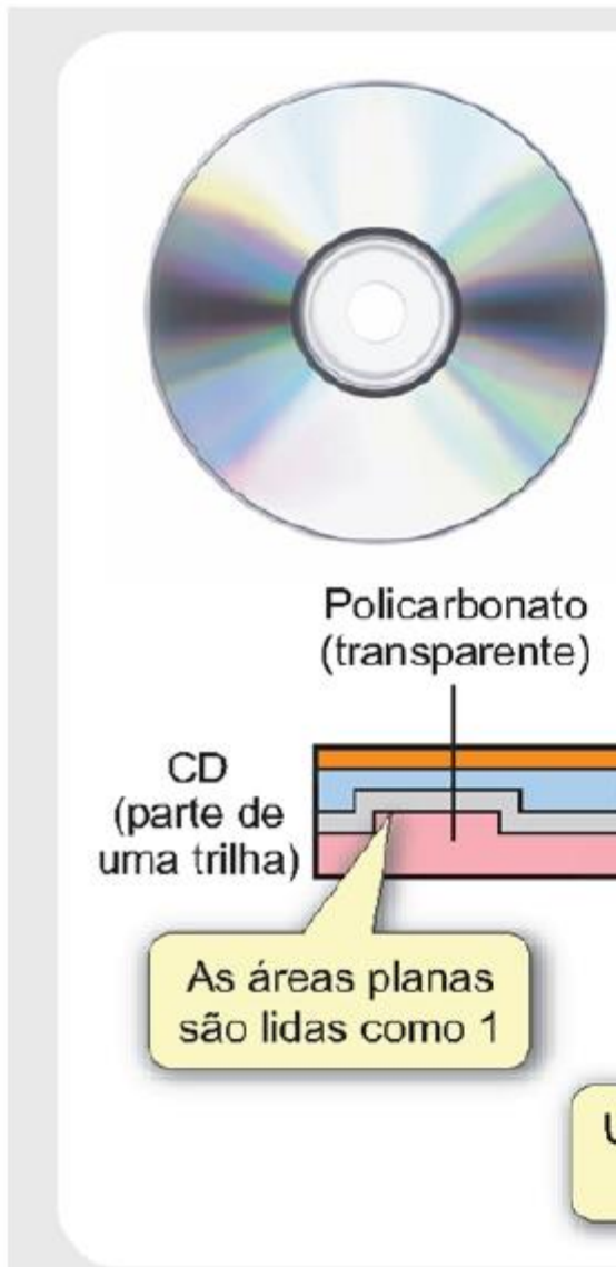
Figura 1 Corte transversal de comercial.
