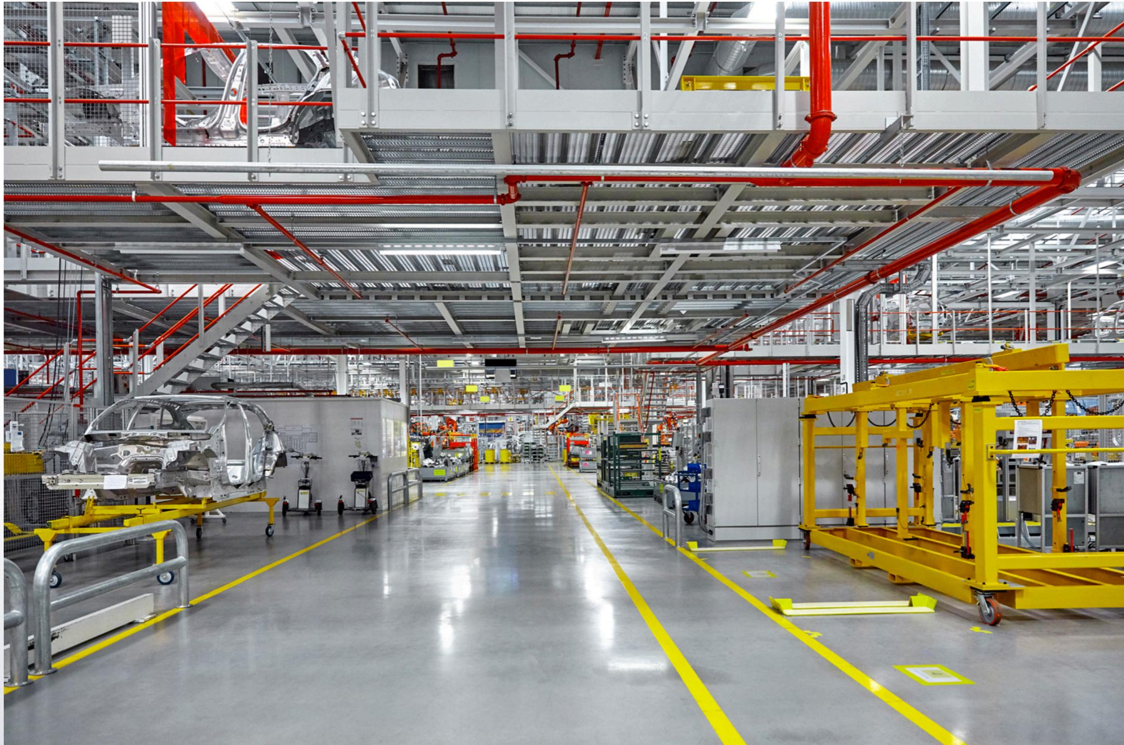
O modelo estritamente linear e pipeline foi praticamente descontinuado e substituído por um modelo em células onde a sequência de “visitas” do artefato pode ser modificada: um sistema flexível.
