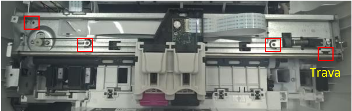
Figura 8. Remoção dos parafusos para desmontar o subsistema de movimentação do carro.
