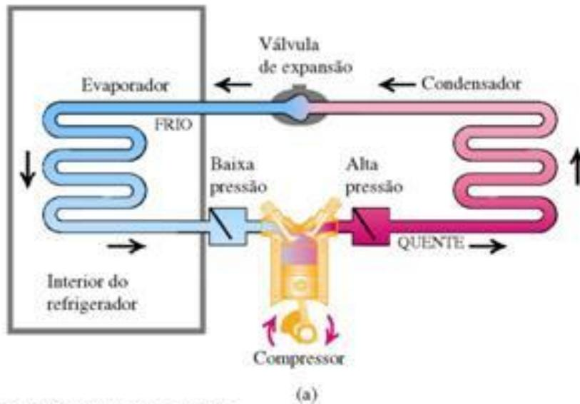
FIGURA 18.6 Diagrama do princípio de funcionamento do ciclo de um refrigerador.
