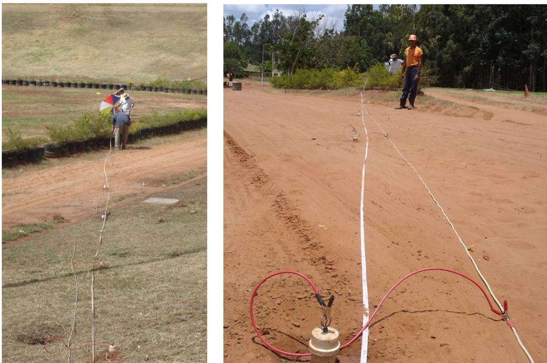
Foto 5.1. Levantamento geofísico 3-D sendo realizado na parte oeste do aterro de resíduos sólidos urbanos de Bauru.
