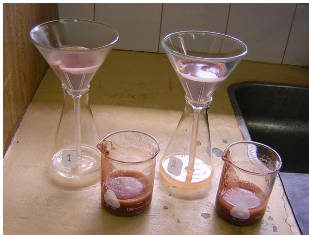
Foto 5.20. Diluição das amostras de solo em água deionizada para medida da condutividade elétrica dos solos.
