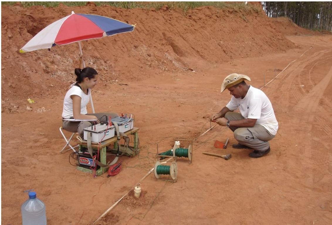
Foto 5.5. SEV-10 sendo executada próxima ao poço PP-13 e do local onde foram coletadas as amostras indeformadas 1 e 2.
