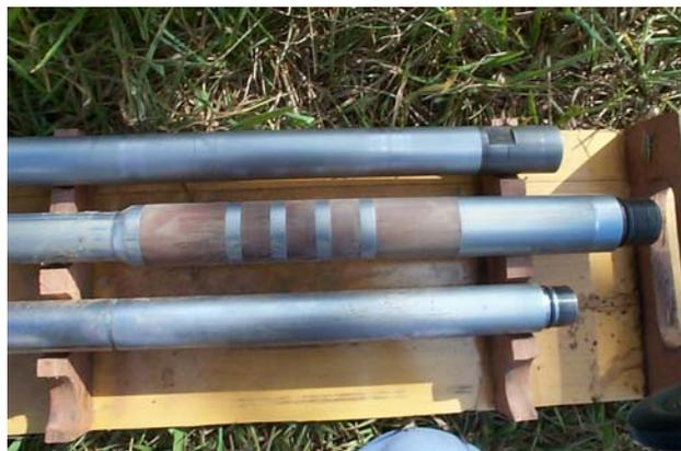
Foto 3.1. Piezocone de resistividade com quatro eletrodos dispostos em arranjo *Wenner*.
