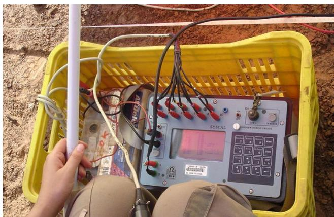
Foto 5.2. Equipamento *Syscal Pro* com 10 canais utilizado durante o levantamento 3-D.
