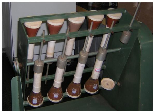
Foto 5.19. Ensaio para medida do pH dos solos (velocidade igual a 42 rpm por 30 min).
