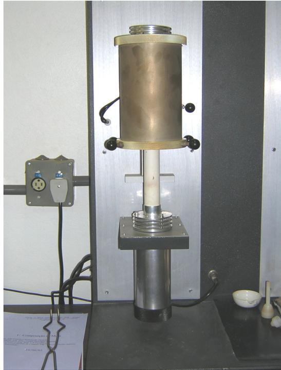
Foto 5.17. Equipamento utilizado para os ensaios de ATD, Departamento de Geotecnia, EESC-USP.
