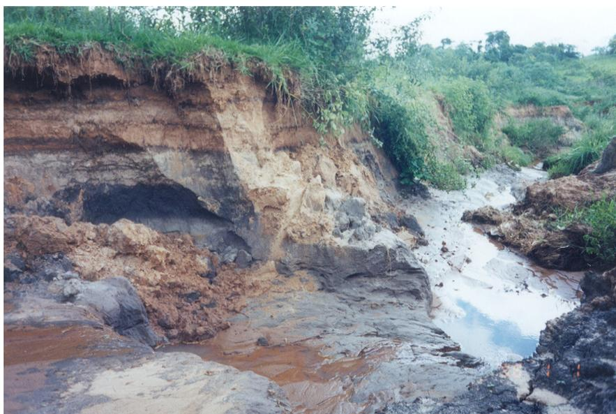
Foto 4.10. Erosão localizada à jusante do aterro de resíduos sólidos de Bauru, onde é possível observar a heterogeneidade do solo que ocorre no local.
