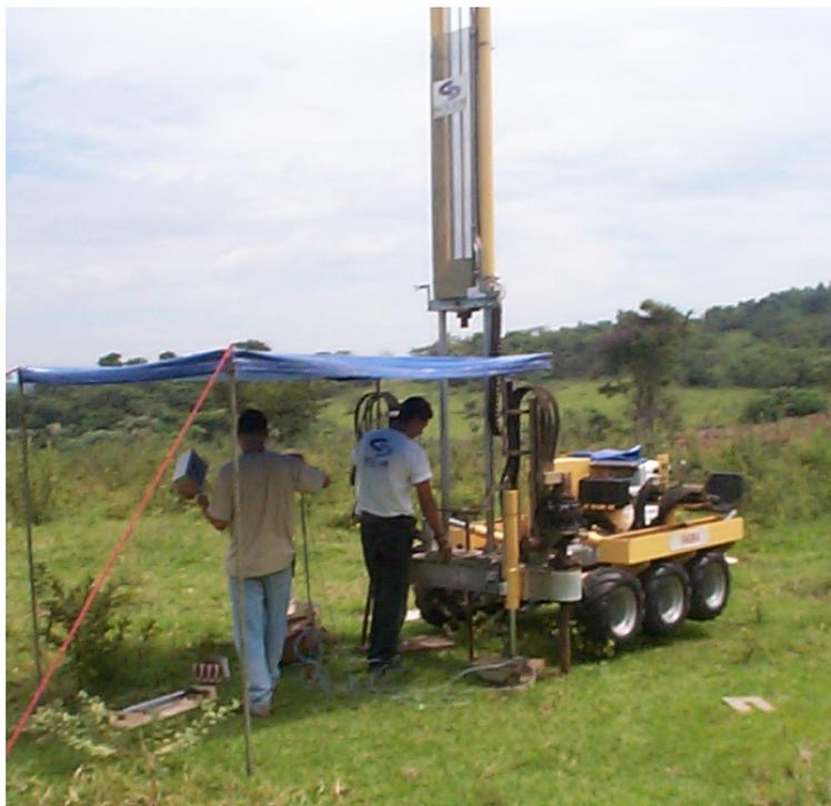
Foto 5.6. Equipamento utilizado para realização dos ensaios de piezocone no aterro de resíduos sólidos urbanos de Bauru.
