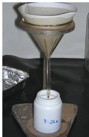
Foto 5.21. Ensaio de equilíbrio em lote em andamento e filtragem das amostras.
