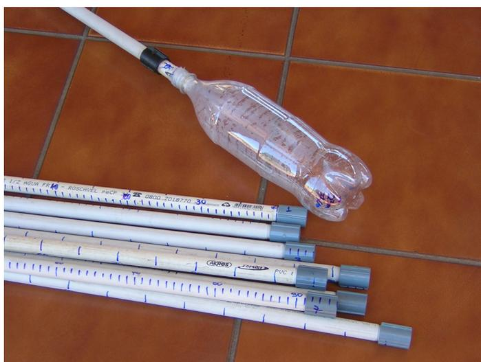
Foto 5.11. Hastes graduadas para medição da elevação do nível d'água após seu esgotamento e bóia feita com garrafa de refrigerante PET de 2 litros.
