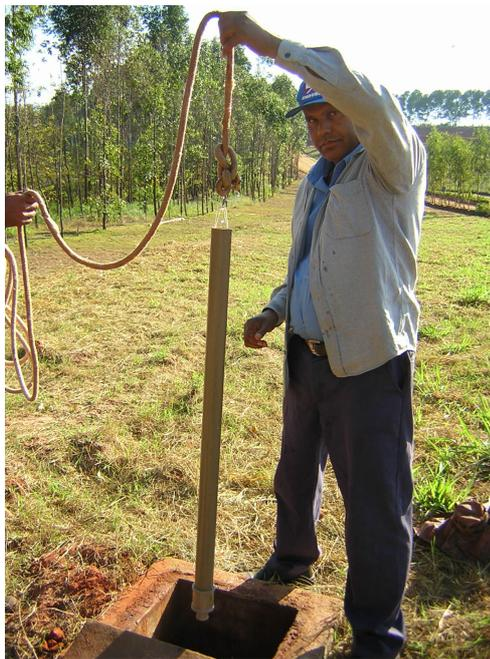
Foto 5.13. Detalhe do *bailer* utilizado durante as coletas de água dos poços, assim como durante a realização do ensaio de dispersão no poço PP-10.
