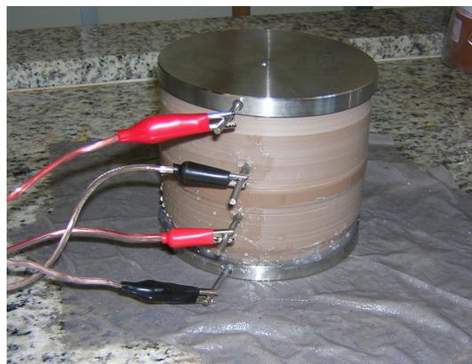
Foto 5.23. Detalhe do sistema desenvolvido para medida de resistividade elétrica em laboratório.
