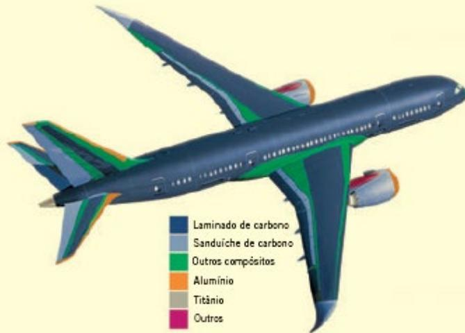
**Figura 16.20** Localização dos vários tipos de materiais usados no Boeing 787 Dreamliner.
