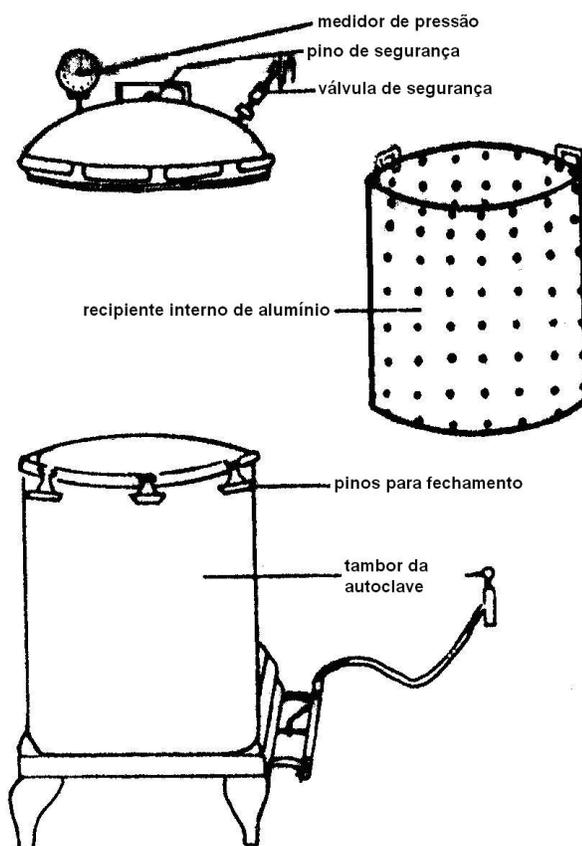
**Figura 13.** Esquema de autoclave usada em aula prática.
