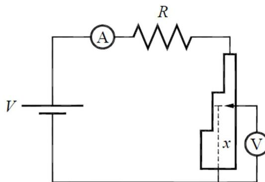
3. Faça um gráfico da tensão em função do comprimento  $x$ , destacando as 3 regiões. Qual o comportamento observado em cada região? Explique o comportamento observado com base nas áreas transversais da fita metálica.
