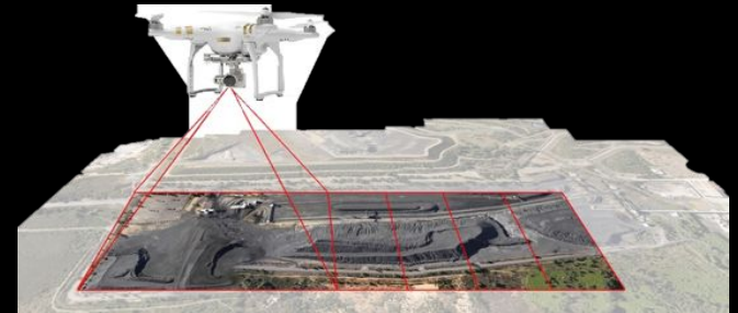
img 02: Esquema aerofotogrametria pro drone: perpendicularidade
