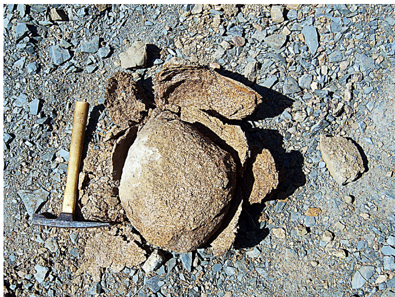
Figura 7.5: Alteração intempérica esférica, resultante da maior intensidade de ataque nos vértices e nas arestas dos blocos do que nas faces; assim a alteração afeta mais intensivamente as partes angulosas dos blocos, arredondando-os e formando camadas sucessivamente mais alteradas na periferia e menos alteradas no interior dos blocos. Este tipo de alteração é mais frequente em rochas ígneas, que não têm orientação interna preferencial dos minerais constituintes, como granitos e basaltos.
