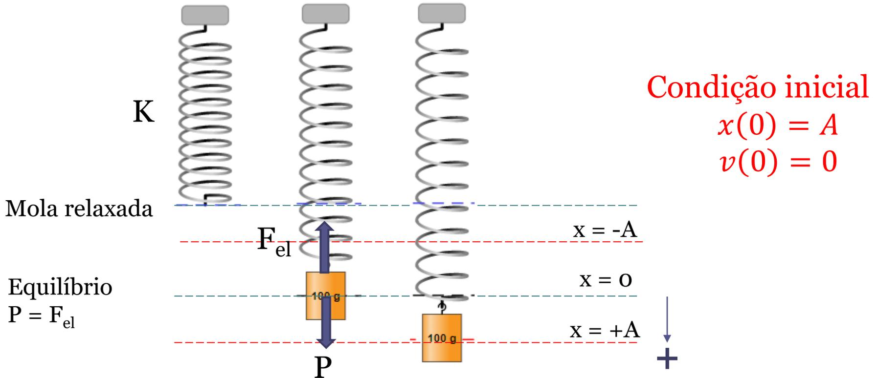
Suponha que um sistema massa-mola na vertical inicie seu movimento a partir da posição  $x=+A$  com velocidade zero. Vamos considerar a origem do sistema de coordenadas como o ponto de equilíbrio entre a força peso e a força elástica, com sentido positivo apontando para baixo.
