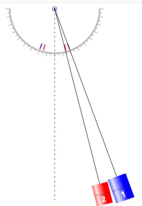
Pêndulos com fase oposta (ou seja, diferença de fase igual a  $\pi$ ): quando um pêndulo atinge uma extremidade da trajetória, o outro pêndulo atinge a extremidade oposta.
