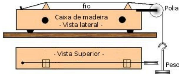
Se utilizamos um peso  $P = 360$  N, verifica-se que, para se obter uma frequência fundamental de vibração da corda de  $f = 200$  Hz, a distância entre as duas cunhas deve ser de  $L = 0,75$  m.
