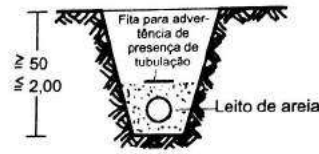
3 Canalizações de gás instaladas no solo; não há necessidade de prevenção contra congelamento
