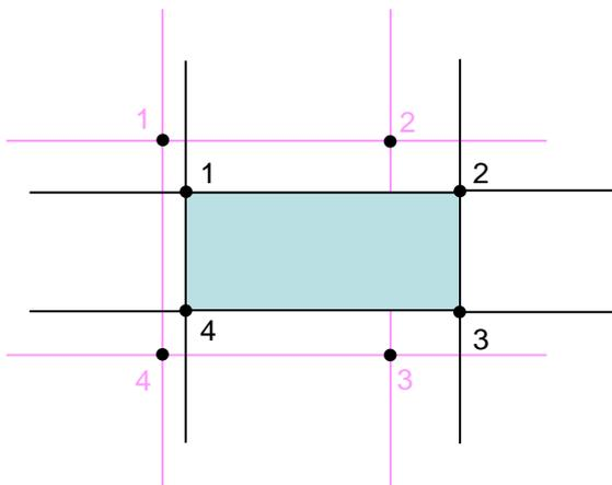
Deslocamentos do nós compatíveis com deslocamento constante ao longo do elemento → deformações calculadas para todo e qualquer ponto no interior do elemento devem ser iguais entre si, compatíveis com um estado de deformação constante ao longo do elemento.
