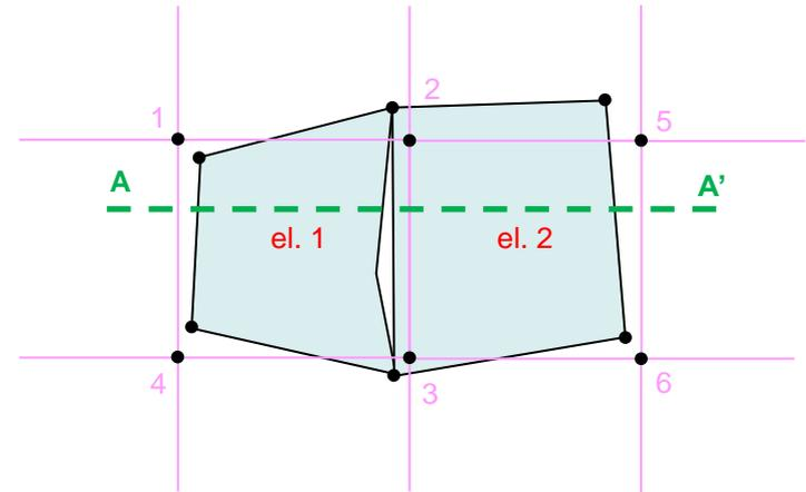
Continuidade de deslocamentos nas arestas comuns dos elementos → OK → aumento da discretização irá levar à continuidade também das deformações → diz-se então um salto de deformação finito.
