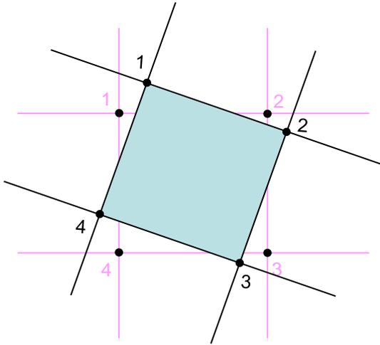
Deslocamentos do nós compatíveis com deslocamento de corpo rígido do elemento → deformação calculada num ponto qualquer no interior do elemento resultante das funções de interpolação deve ser nula!
