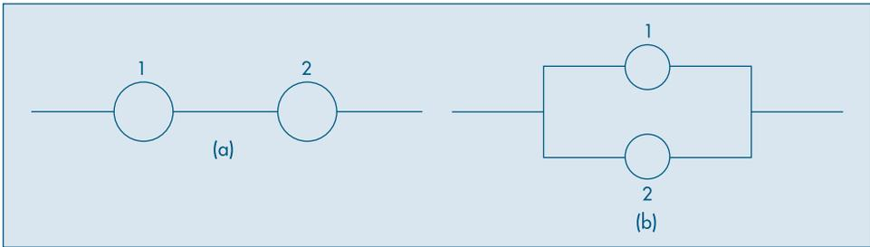
O sistema da figura funcionará se os componentes 1 e 2 funcionarem simultaneamente. Se um dos componentes falhar, o sistema também falhará. Supondo que os componentes funcionem *independentemente*, e se  $p_i$  for a probabilidade de o componente  $i$  ( $i = 1, 2$ ) funcionar, então a probabilidade de o sistema funcionar será
