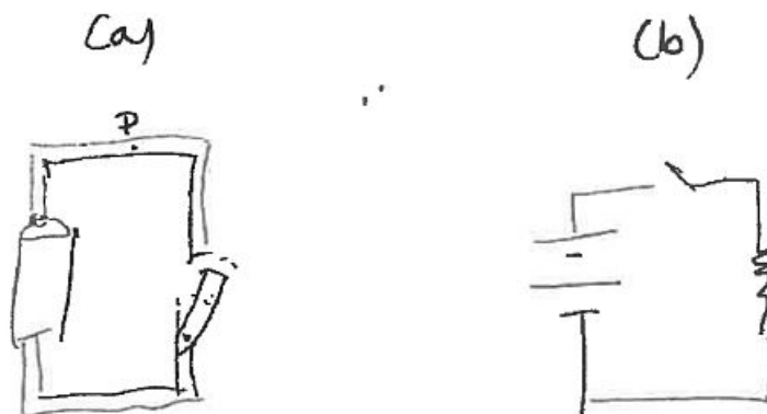
Figura 26.6: (a) Fio ligado a uma bateria com o interruptor aberto; (b) representação do sistema.
