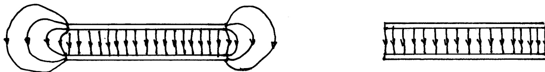
Figura 18.2: O campo elétrico de um capacitor de placas paralelas: (a) situação real; (b) modelo adequado quando R \gg a .
