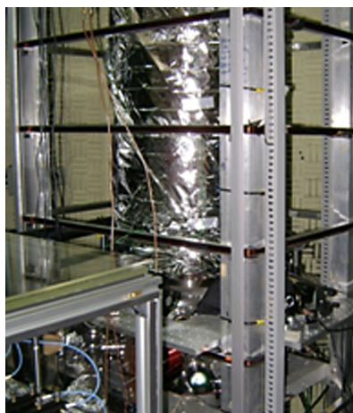
Figura 12.5: Fotografia do relógio atômico do IFSC-USP, baseado em átomos de césio resfriados a laser, atualmente o mais preciso relógio da América Latina.
