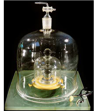
Figura 12.4: O quilograma padrão é até hoje um artefato físico (pequeno cilindro metálico, no interior de redomas de vidro) que define o padrão de massa.
