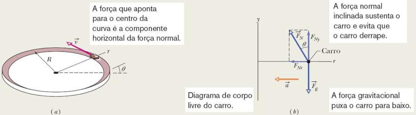
**Figura 6-11** (a) Um carro faz uma curva compensada com velocidade constante  $v$ . O ângulo de inclinação está exagerado para maior clareza. (b) Diagrama de corpo livre do carro, supondo que o atrito entre os pneus e a estrada é nulo e que o carro não possui sustentação negativa. A componente radial  $F_{Nr}$  da força normal (ao longo do eixo radial  $r$ ) fornece a força centrípeta e a aceleração radial necessárias para que o carro não derrape.
