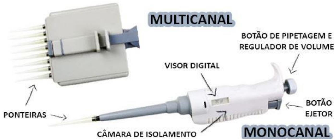
Partes da micropipeta.
