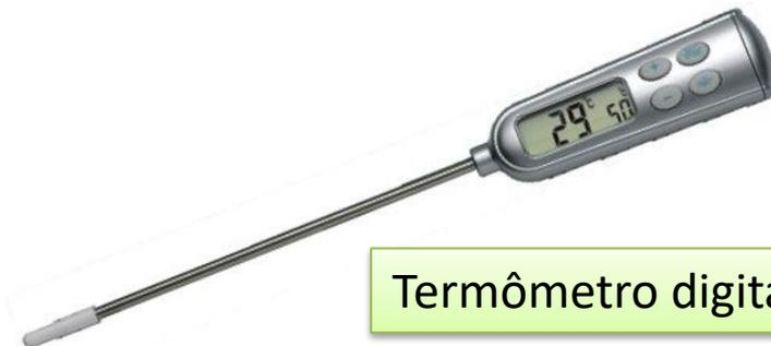
Termômetro digital (termopar)
